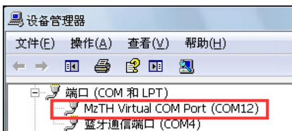
随后打开 EzUI\_Simulate 工具软件，将工具软件设置为在线同步联调模式，选择 USB 接口同步联调，然后按照识别出的虚拟串口进行端口配置，最后打开串口。完成配置后，打开为 EzUILet035 模块制作的资源文件，即可进行资源文件下载操作。
